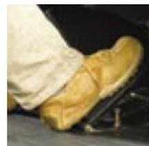
**PEDALES DE ESTILO AUTOMOVILÍSTICO** se encuentran posicionados de modo que se reduzca la fatiga. Pedales separados para freno y para avance lento facilitan un excelente reinicio escalonado y el acoplamiento de la transmisión.
