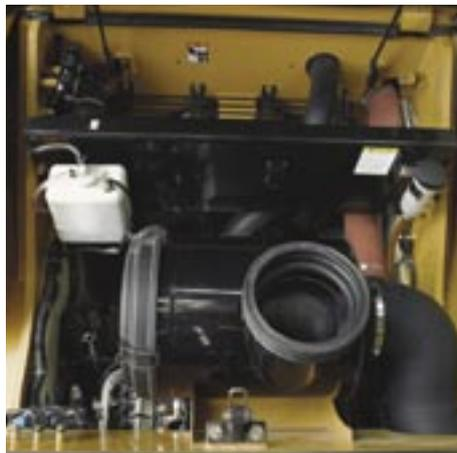
**LAS SENCILLAS REVISIONES DIARIAS** (*arriba*) de los niveles de refrigerante, aceite del motor, aceite de la transmisión, aceite hidráulico y aceite de los frenos se puede efectuar a través de indicadores de medida situados adecuadamente a la vista, que no requieren herramientas especiales ni la inclinación del habitáculo del operador.
