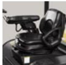
**UN ASIENTO CON SUSPENSIÓN COMPLETA** que incorpora ajustes de peso y de posición hacia adelante y hacia atrás, soporte del reposacabezas, sistema de contención de la cadera y cinturón de seguridad. También incluye un interruptor del asiento para la "detección de presencia" del operador y una alarma sonora del cinturón de seguridad que avisa si no se ha abrochado.
